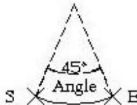
Hình 2.23 – Vẽ cung tròn khi biết điểm đầu, điểm cuối và góc ở tâm
